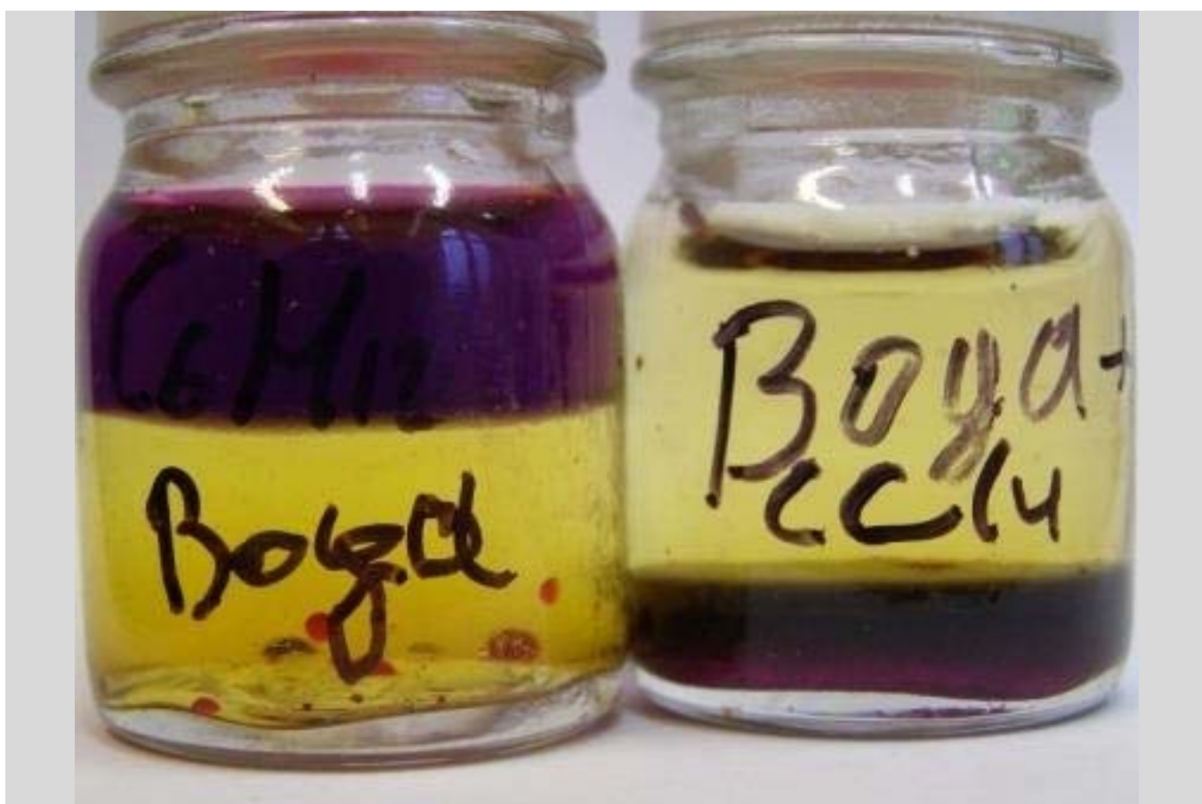
Экстракция иода из водного раствора циклогексаном (слева) и \text{CCl}_4 (справа). фото В.Н. Витер.
