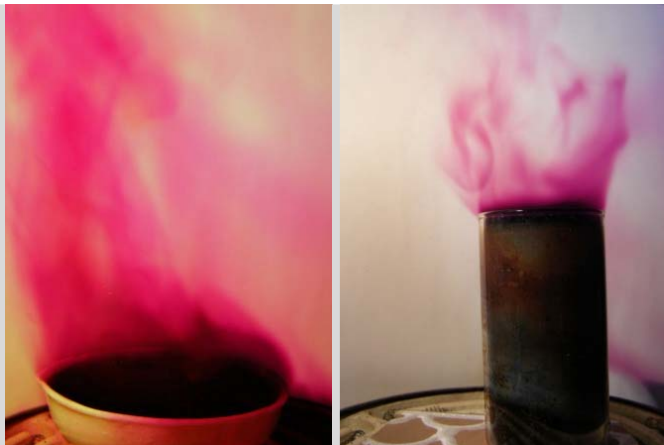
Сублимация иода на горячих поверхностях. фото В.Н. Витер
