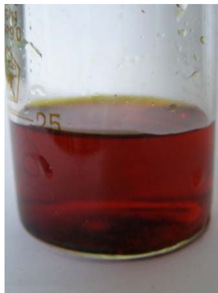
Взаимодействие \text{K}_2\text{Cr}_2\text{O}_7 и \text{KI} фото В.Н. Витер
